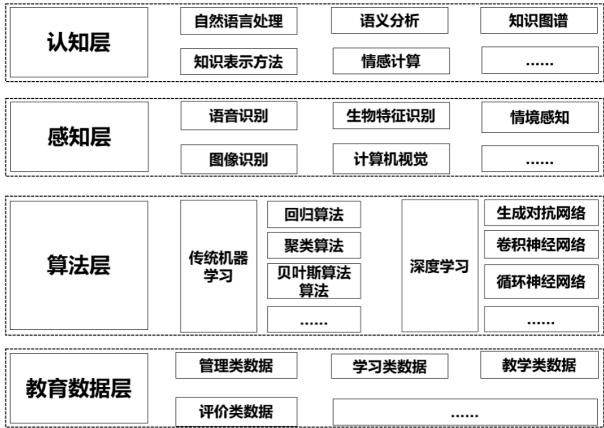
图 1 人工智能的技术框架
